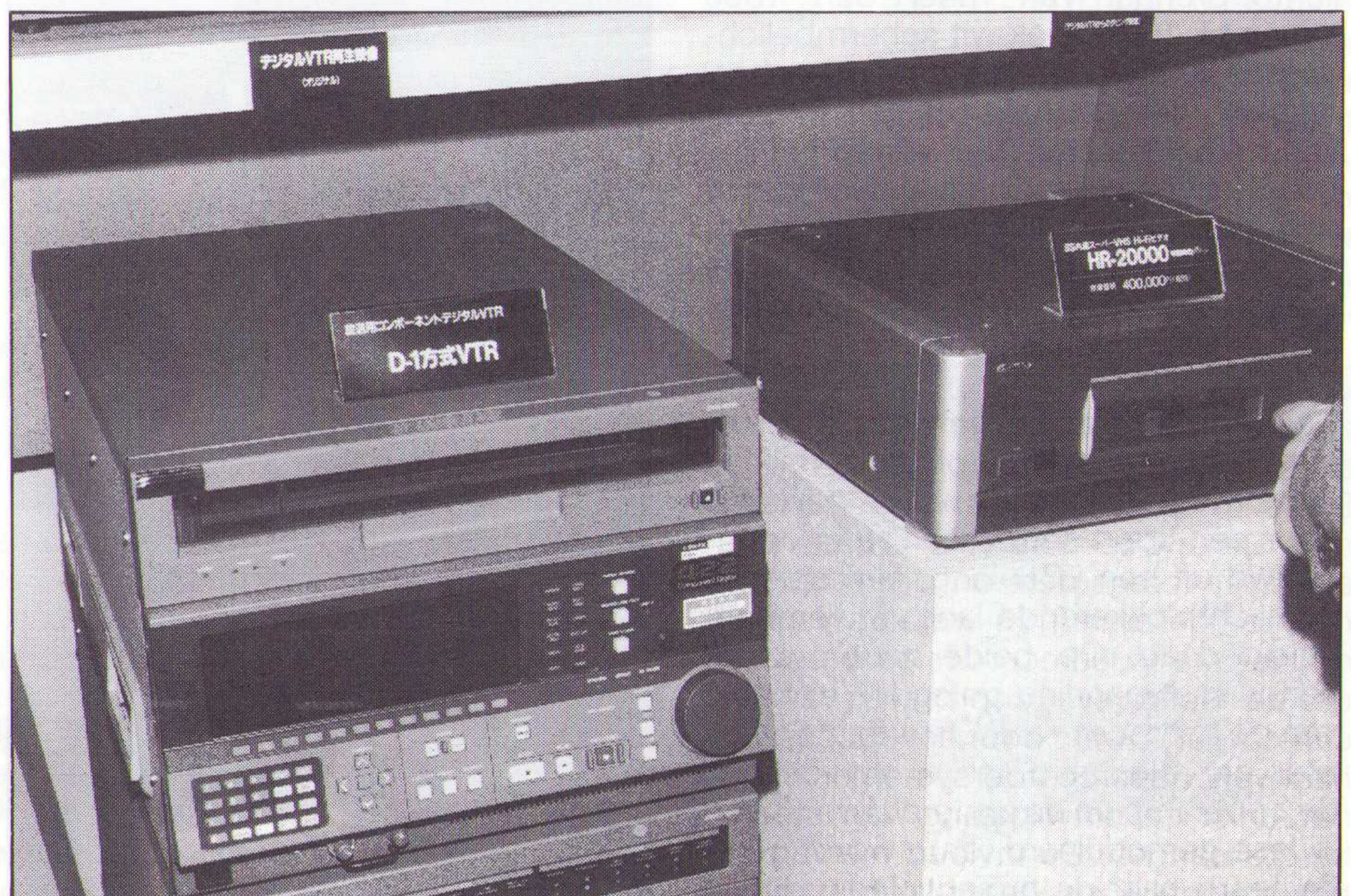
Fig. 4 Beeldvergelijking tussen een D1 digitale componentenrecorder. en The Reference VHS-recorder HR-20000 (rechts).
